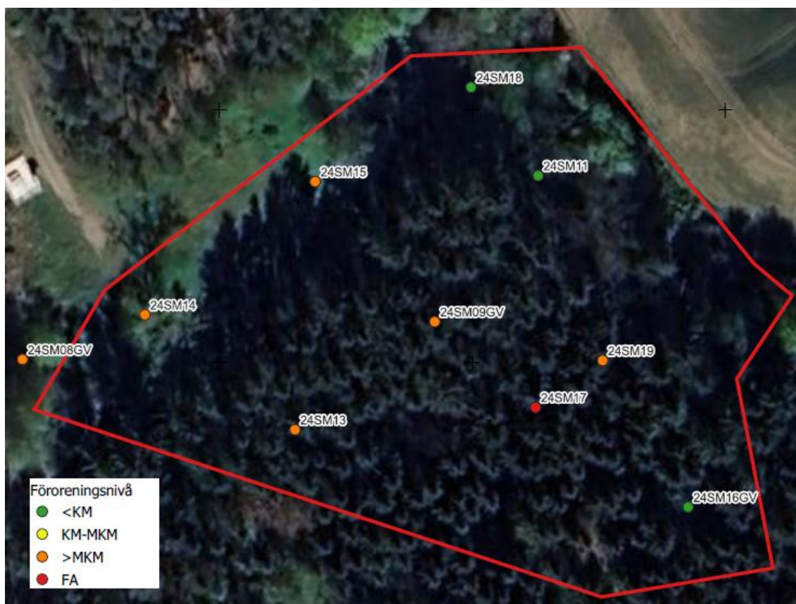
Figur 7 Analysresultat i jord tillsammans med rödmarkerad linje som visar uppskattat deponiområde. Figuren visar högsta uppmätta föroreningsnivåer av samtliga ämnen som analyserats i jord.
