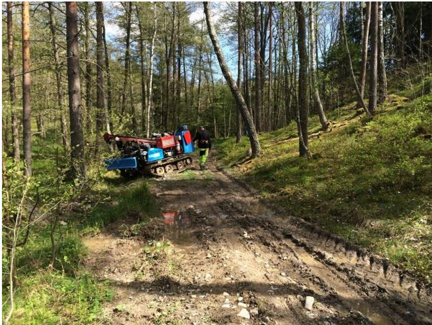
Bild 22: Borrning vid detaljerad geoteknisk undersökning.
