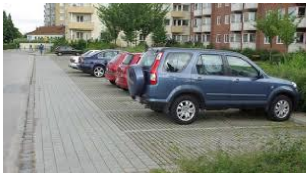
Figur 15) Genomsläpplig beläggning på parkeringsyta. Bild hämtad från Stockholm vatten och avfall.
