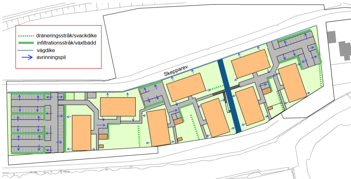
Figur 17) Principskiss över dagvattenhantering inom planområdet.
