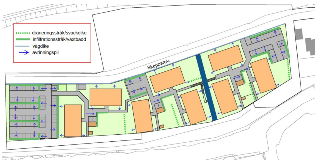
Bild 45. Principskiss över föreslagen dagvattenhantering inom planområdet som visar genomsläppliga ytor samt avrinningsriktning dagvatten. Exempel på utformning. Källa: Tyréns AB.
