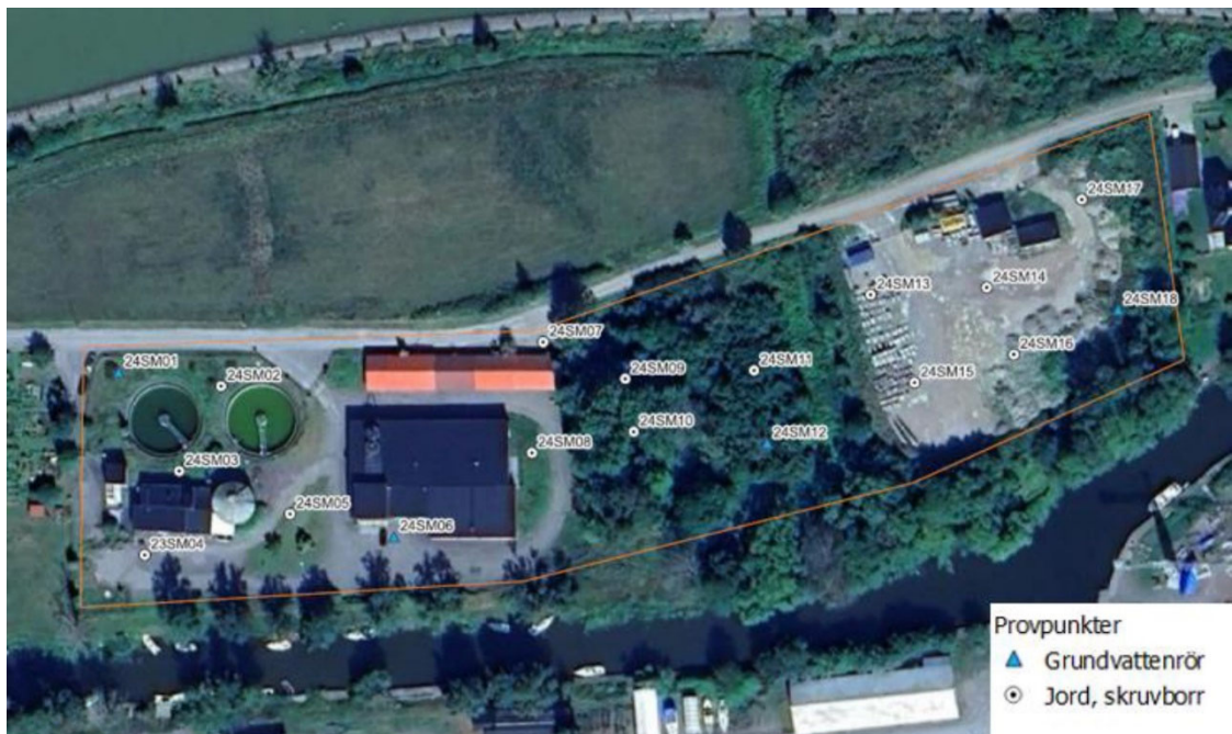
Bild 35. Bilden visar genomförda provpunkter för jord och grundvatten. Blå trianglar är grundvattenrör där även jordprov uttas och vita punkter är jordprov. Källa: Översiktlig miljöteknisk markundersökning, upprättad 2024-05-24 (Structor Miljö Öst AB).
