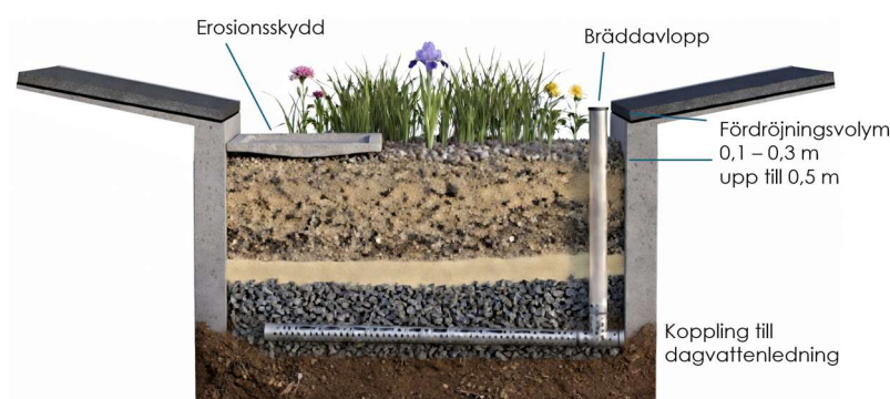
Figur 39. Principskiss för nedsänkt växtbädd med ytlig fördröjningsvolym och dränering
