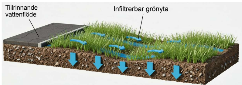
Figur 29. Principskiss för infiltration i grönyta med bred avledning och skålform
