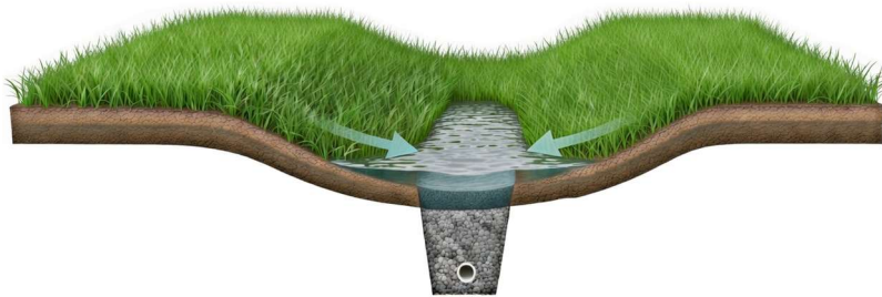
Figur 37. Principskiss för svackdike
