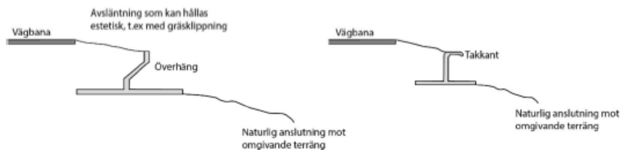
Figur 32. Utformningsprincip för kräldjursbarriär, sektion. Hämtad från TRV publikation 2021:003 Råd - VGU
