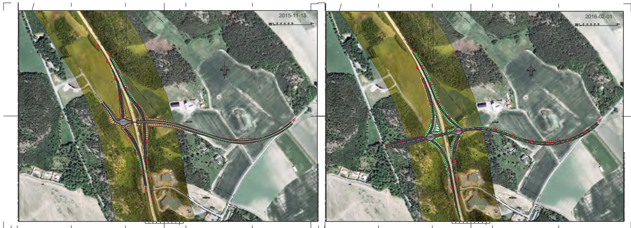
Figur 5. Till vänster: Bortvalt alternativ 1 med väg 843 liggande under E22 med avfart till Slussportens industriområde via väg som rundar berget västerut. Till höger: Alternativ 2 för utformning av Slussportens trafikplats som valts för E22 förbifart Söderköping och möjliggörs av denna detaljplan (ÅF, 2016a).
