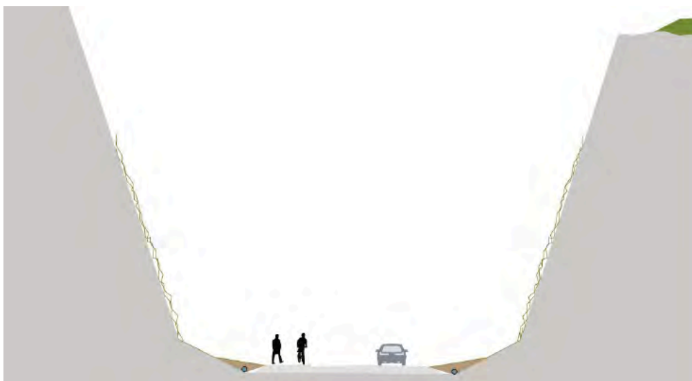
Figur 22. Sektion bergsskärning med täckt dike med artrik vägflora. Illustration: Radar.
